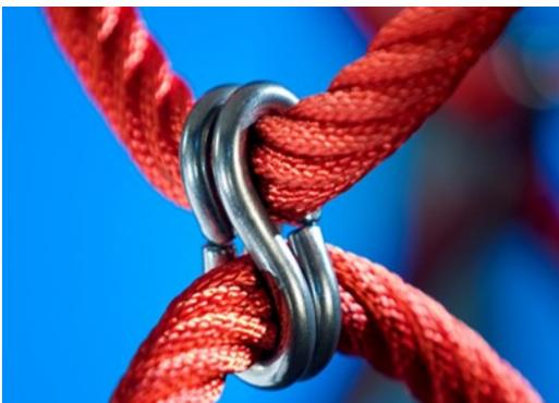
Die Corocord-S-Klemmen werden als universale Verbindungselemente für Corocord Produkte eingesetzt. 8 mm Stangen aus rostfreiem Edelstahl, mit abgerundeten Kanten werden mit einem hydraulischen Spezialwerkzeug auf die Seile gepresst und sind damit ideale Verbindungselemente: sicher, langlebig und vandalismusresistent, ohne dabei die typischen Bewegungen von Seilspielgeräten zu stören.
