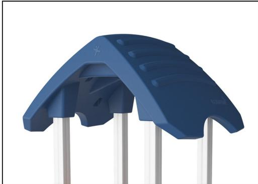
Les grandes pièces sont creuses et fabriquées en polyéthylène (PE) 100 % recyclable. Le toit est moulé en une seule pièce avec une épaisseur minimale de 5,5 mm afin d'assurer une durabilité élevée dans tous les climats du monde.
