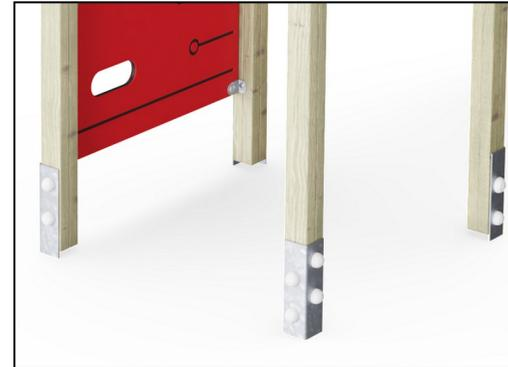
Les poteaux principaux sont équipés de pieds en acier galvanisé à chaud. Les pieds en acier surélevent les poteaux de 20 mm du niveau du sol pour éviter tout contact avec le revêtement de surface.
