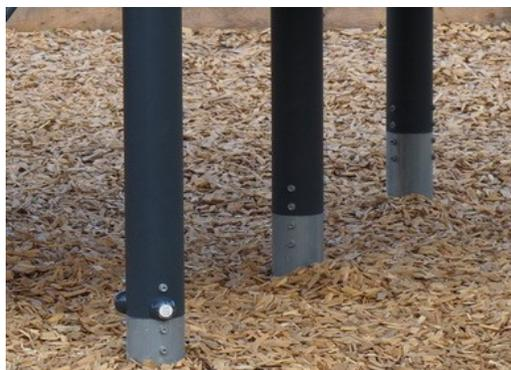
Les poteaux principaux avec le pied en acier galvanisé à chaud sont disponibles en différents matériaux : Poteaux en bois de pin imprégnés sous pression, poteaux en acier prégalvanisé à l'intérieur et à l'extérieur avec une finition de surface thermolaquée, poteaux en aluminium sans plomb avec couleur anodisée en finition de surface.
