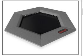
橡胶砖由灰色的 SBR 再生橡胶,苯乙烯丁二烯 单体橡胶模制而成,而 KOMPAN 徽标则由 EPDM 乙烯丙烯二烯单体制成。 每个橡胶砖的内 部都有一个 3 毫米的热浸镀锌钢板。
