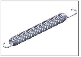
所有 36 个弹簧均由不锈钢制成,以确保耐用性和 出色的耐腐蚀性。钢丝为 3.2 毫米厚,最后五个 绕组为圆锥形,以确保跳线的长寿命。
