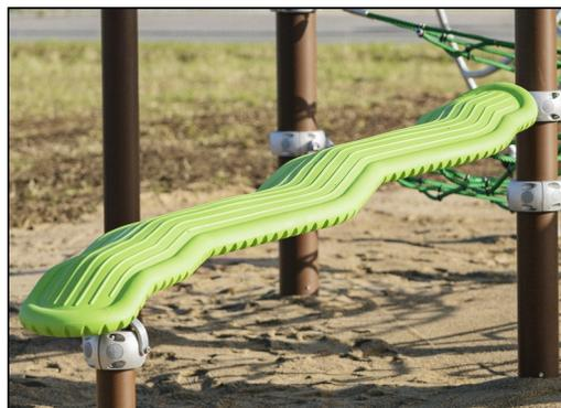
Der Wackelbalken besteht aus PE mittlerer Dichte mit hervorragender Schlagzähigkeit und ist für einen grossen Temperaturbereich geeignet. Die hohlen Kunststoffteile bestehen aus 100% recycelbarem PE, das zu 33% aus Post-Consumer-Materialien hergestellt wird. Geformt in einem Stück mit einer Wandstärke von mindestens 5 mm. Die Längsrillen bieten eine rutschfeste Oberfläche für sicheres Spielen.
