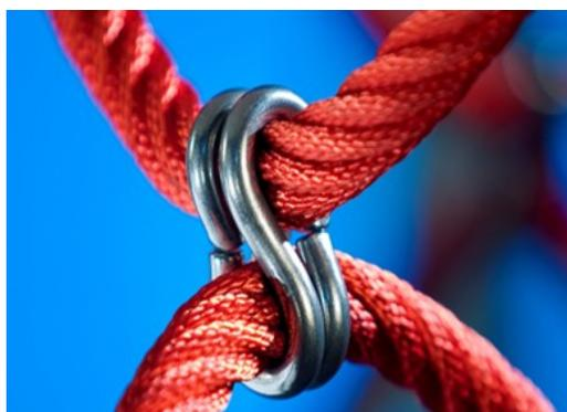
Die Corocord-S-Klemmen sind universale Verbindungselemente aus rostfreiem Edelstahl mit einem Durchmesser von 8 mm. Die Klemmen sind abgerundet und das gesamte Bauteil wird mit hydraulischen Spezialwerkzeugen auf das Seil gepresst. Daher können die Klemmen mit herkömmlichen Werkzeugen nicht entfernt werden.
