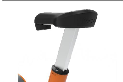
Der Sitz besteht aus spritzgegossenem, weichem PUR mit einer pulverbeschichteten Stahleinlage aus S235-Stahl. Die Nutzer können zwischen 9 verschiedenen Sitzhöhen wählen, die zwischen 845 mm und 995 mm liegen. Der Sitz ermöglicht es Nutzern mit einer Körpergröße von 150 cm bis 195 cm, das Fahrrad bequem zu nutzen.
