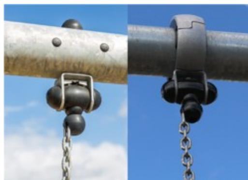
Les suspensions pivots sont fabriquées en nylon de haute qualité stabilisé aux UV (PA6) avec des roulements à billes intégrés et scellés à vie. Les chaînes réglables en hauteur sont fixées par un crochet en acier inoxydable avec un boulon snake-eye antivolt dans un boîtier rotatif anti-torsion. Tous les sièges avec deux chaînes de fixation sont disponibles avec une suspension standard ou une suspension anti-enroulement.
