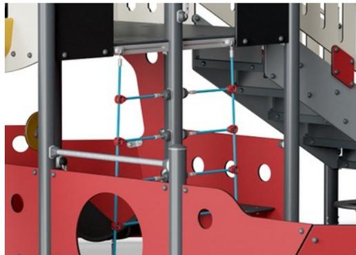
Seile aus UV-stabilisierten PES-Seilsträngen mit innerer Stahlseilverstärkung. Das Polyestergerüst wird aus +95 % Post-Consumer-Materialien hergestellt und induktiv auf jede Litze aufgeschmolzen.
