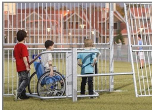
Der Rollstuhlzugang besteht aus einem 80 x 80 x 3 mm Pfosten mit einem Ø 48 mm Rohr und 2 Scharnieren aus 16 mm Edelstahl. Die Öffnung ist 95cm breit und 112cm lang, was Rollstuhlfahrern den Zugang zum MUGA ermöglicht, aber Mopeds und Motorräder stoppt.
