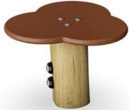
Los escalones están hechos de madera contrachapada de 21,5 mm de espesor hecha de aliso y madera de pino. Ambos lados están cubiertos por 2 capas de película fenólica con patrón de red antideslizante. Todos los bordes de corte están sellados con pintura para garantizar una larga vida útil.
