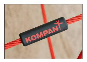
Seile aus UV-stabilisierten PES-Litzen mit innerer Stahlseilverstärkung. Das Polyestergarn besteht aus +95% Post-Consumer-Materialien und wird induktiv auf jede Litze aufgeschmolzen. Damit sind die Seile besonders beständig gegenüber Abnutzung und Vandalismus und können jederzeit vor Ort ausgetauscht werden.
