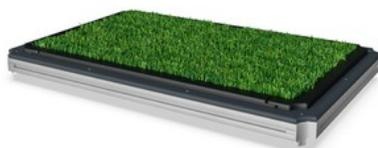
El área de césped es de 1210x710 mm. El césped es sintético, que está pegado a la placa HPL con adhesivo de poliuretano (Henko H400 o H700). La placa HPL tiene orificios de drenaje para eliminar el agua rápidamente.
