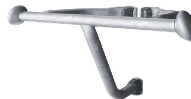
La poignée de support a une largeur de 530 mm. La poignée est à 1050 mm au-dessus du niveau du sol et à 1140 mm au-dessus de la membrane du cavalier. Le manche est constitué d'une barre HDG Ø32mm.
