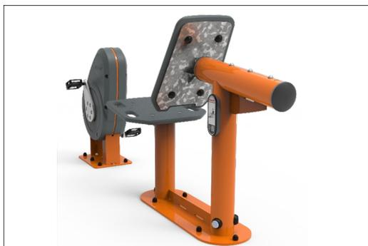
Per garantire l'integrità della macchina, i montanti principali di colore arancione sono realizzati in acciaio S235 con diametro  $\varnothing 101.6$  mm e spessore di parete di 3 mm, zincati a caldo e verniciati a polvere.
