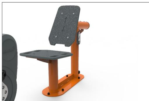
La seduta e lo schienale sono realizzati con pannelli Ekogrip™ composti da una base di PE spessa 15 mm e uno strato superiore morbido di gomma spesso 3 mm, con effetto antiscivolo. Lo schienale è regolabile e l'utente può scegliere tra 6 diverse distanze rispetto alla bicicletta.
