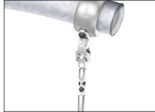
秋千吊架由不锈钢支架制成，可以在两个轴上移动。法兰轴承富含硅树脂，使悬架免维护。绳索的连接由不锈钢链条制成。
