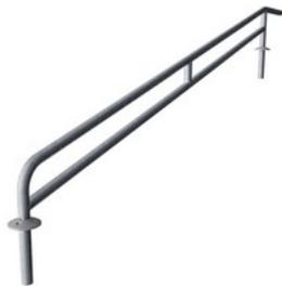
Die Geländerhöhe beträgt 930 mm und der Abstand zwischen den Geländern 900 mm. Das für das Geländer verwendete Material ist feuerverzinkter Stahl mit einem Durchmesser von 38mm, was einen guten Halt und eine Unterstützung für das Handgelenk bietet.
