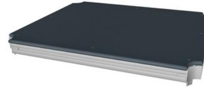
Alle Plattformen werden durch speziell druckgeformte Aluminiumverbindungen gestützt und können je nach Wunsch befestigt werden. Die HPL-Plattformen sind 17,8 mm stark und besonders beständig gegenüber Abnutzung. Die einzigartige KOMPAN Oberfläche sorgt zudem für Rutschfestigkeit und Sicherheit.
