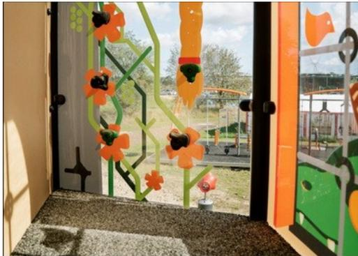
Hochwertiges Polycarbonat mit einer Dicke von 15 mm. Die grafischen Drucke werden durch ein einzigartiges Mehrschichtdruckverfahren hinzugefügt, bei dem die innere Schicht das Bild darstellt und die äußere transparente Schicht als Schutz dient. Sowohl die PC-Wände als auch der Lack auf Wasserbasis sind UV-stabilisiert, um ein Ausbleichen zu verhindern.
