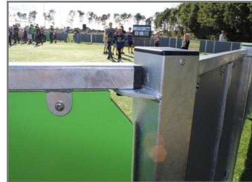
Los paneles de HDPE están conectados con pernos de acero inoxidable M8 a bridas soldadas de 42.5 x 40 x 3 mm. Estas conexiones no son visibles desde el interior y crean una conexión fuerte y segura.
