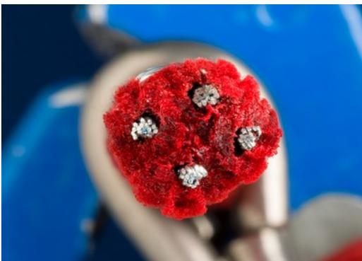
Le corde Corocord da 16 mm sono di tipo "Hercules" con fili di acciaio a quattro fili zincati e un nucleo di filo di acciaio. Ogni filo è strettamente avvolto con filo PES, che viene fuso su ogni singolo filo. Le corde sono altamente resistenti all'usura e agli atti vandalici e possono essere sostituite sul posto, se necessario.
