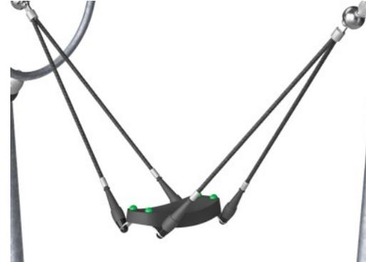
Die Galaxy-Seile verfügen über sechslitzige Stahldrahtseile, die mit einem Stahlkern versehen sind. Jede Litze ist mit PES-Garn umwickelt, das induktiv auf jede Litze aufgeschmolzen wird. Das PES-Garn besteht aus +95 % Post-Consumer-Material und ist äußerst beständig gegenüber Abnutzung und Vandalismus.
