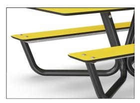
Die Platten für Sitzflächen, Tischplatten und Rückenlehnen sind aus Hochdrucklaminat (HPL) mit einer Stärke von 17,8 mm gemäß EN 438-6 hergestellt und haben eine rutschfeste Oberflächenstruktur. Der mehrschichtige Aufbau macht die Platten langlebig und geeignet für den Außenbereich mit einer hohen UV-Stabilität und hoher Beständigkeit gegen Stöße, Kratzer, Feuer, Wasser und Feuchtigkeit.
