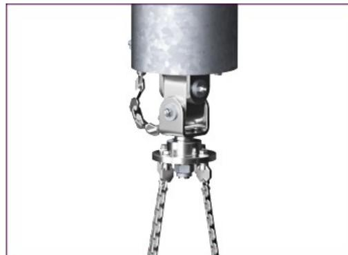
Speziell entwickelte 360°-Schaukelaufhängungen aus Edelstahl mit Anti-Überschlag-Funktion. Die Aufhängungen sind dauergeschmiert und versiegelt. Das Aufhängungssystem ist mit einer Sicherheitskette ausgestattet, um das Herunterfallen der Schaukelaufhängung bei Beschädigung zu verhindern.
