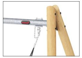
KOMPAN 设计的重载型不锈钢秋千吊架具有防扭曲功能。吊架通过两个螺栓固定在焊接支架上的横梁上。轴承内嵌硅酮润滑剂,无需进一步润滑。
