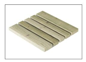
I pannelli sono realizzati in legno di pino proveniente da fonti europee sostenibili. Il legno è impregnato a pressione secondo la norma EN335:2013, Classe 3 (equivalente a NTR Classe AB). Su richiesta, può essere fornito con certificazione FSC® (FSC® C004450).
