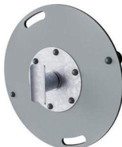
La boîte de palier est fait d'acier galvanisé par immersion à chaud. L'arbre de roulement est fabriqué en acier inoxydable AISI304. Le roulement est, lui, fabriqué à partir de polyoxyméthylène (POM), une résine thermoplastique dotée d'une grande rigidité, un faible frottement, et une excellente stabilité dimensionnelle.
