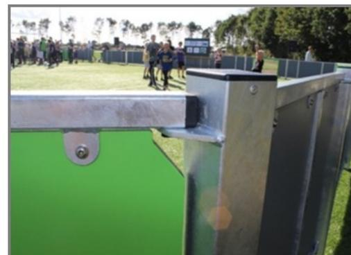
Die Polyethylen-Banden (HDPE) sind durch Edelstahlschrauben (M8 Gewinde) mit 42.5 x 40 x 3 mm grossen, geschweissten Flanschen verbunden. Diese Verbindungen sind von innen nicht sichtbar und bilden eine stabile und sichere Verknüpfung.
