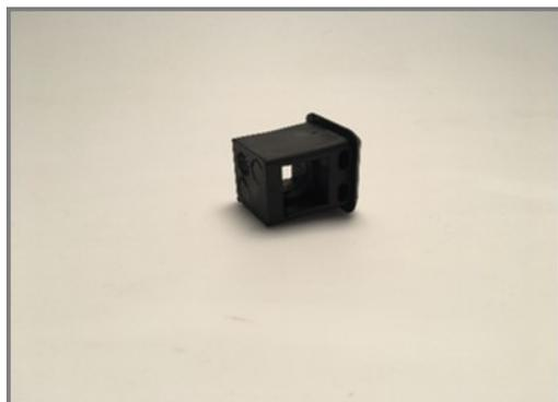
Jede Platte hat 4 thermoplastische Vulkanisatanschlüsse, welche die Platten mit den Pfosten verbinden. Die Anschlüsse reduzieren die Vibration und somit auch den Geräuschpegel. Die Anschlüsse vereinfachen ausserdem die Montage, da Sie mit vormontierten Muttern geliefert werden.
