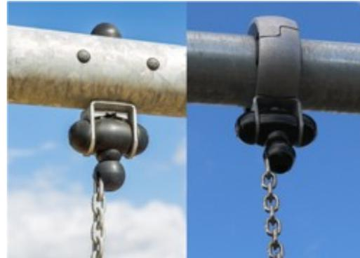
Los colgadores de los columpios están hechos de una carcasa de nylon de alta calidad estabilizada contra rayos UV (PA6) con rodamientos de bolas sellados de por vida integrados. Las cadenas ajustables en altura se fijan mediante un gancho de acero inoxidable con perno de ojo de serpiente antirrobo en una carcasa giratoria antivuelco. Todos los asientos con fijación de dos cadenas están disponibles con suspensión estándar o anti-envoltura.
