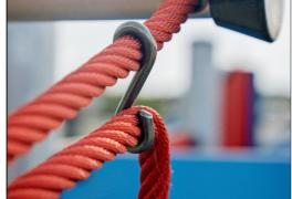
Les crochets en « S » de Corocord sont universellement utilisés dans les produits Corocord. Les tiges en acier inoxydable de 8 mm avec bords arrondis sont pressées autour des cordes avec une pince hydraulique spéciale, ce qui en fait le connecteur idéal : sûr, durable et anti-vandalisme, tout en permettant le mouvement typique des structures ludiques à cordes.
