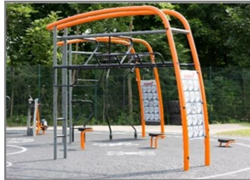
Pour assurer l'intégrité du cadre principal, les poteaux principaux de couleur orange sont en acier de diamètre de 101,6 x 3 mm, galvanisés à chaud et enduits de poudre orange (RAL2010). Les poteaux de soutien reçoivent le même traitement de surface et sont faits de tubes d'acier de diamètre 76,1 x 3,6 mm, enduits de poudre grise (RAL7012).
