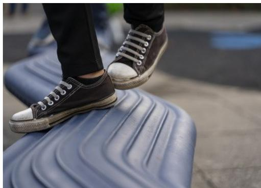
Der Wackelbalken besteht aus PE mittlerer Dichte mit hervorragender Schlagzähigkeit und ist für einen grossen Temperaturbereich geeignet. Die hohlen Kunststoffteile bestehen aus 100% recycelbarem PE, das zu 33% aus Post-Consumer-Materialien hergestellt wird. Geformt in einem Stück mit einer Wandstärke von mindestens 5 mm. Die Längsrillen bieten eine rutschfeste Oberfläche für sicheres Spielen.
