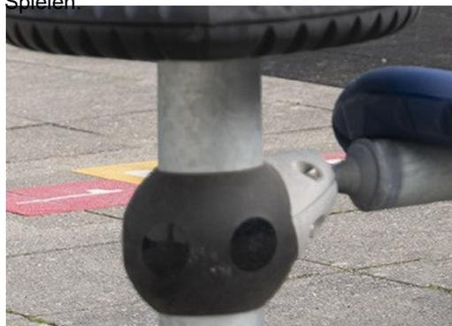
Die Aufhängevorrichtung ist mit einem geschweisstem Stahlkern und einem Gehäuse mit niedriger Dichte (PE) versehen. Die zwei gummibeschichteten Griffe sind angewinkelt, um die bestmögliche ergonomische Haltung zu haben, während man gleitet. Die Räder der Vorrichtung bestehen aus geräuscharmen TPU und werden mit installierten Kugellagern angebracht.
