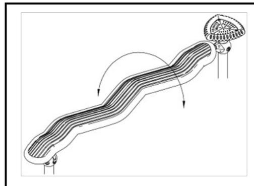
Das Wackeln wird über ein feuerverzinktes Stahlrohr (Ø76x4 mm) ermöglicht, das durch 5 Nylon-Klemmen (PA6) an dem Wackelbalken angebracht ist. Dies ermöglicht, dass sich der Wackelbalken um 25 Grad nach unten oder oben dreht.
