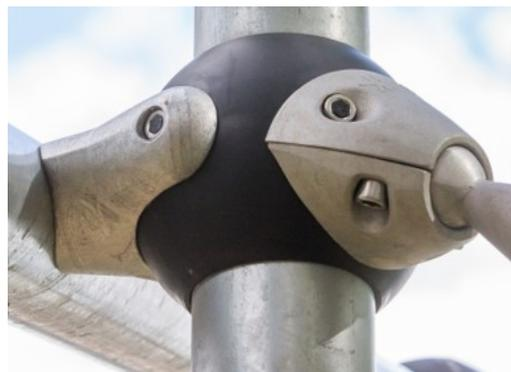
L'esclusiva sfera di connessione GALAXY è realizzata con un'anima circolare interna in alluminio circondata da un guscio di PP rigido con uno strato esterno di morbida gomma TPV. I connettori flessibili in alluminio senza piombo consentono l'installazione in angoli variabili.
