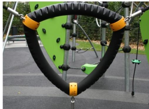
Triangolo rampicante GALAXY con strato esterno morbido di PUR e staffe angolari in nylon stampato (PA6). Il nucleo è costituito da un telaio in acciaio saldato verniciato a polvere con punti di sospensione angolari integrati. I triangoli più grandi sono chiusi con un pannello Ekogrip® di 18 mm di spessore che ha uno strato superiore di gomma con un effetto antiscivolo.
