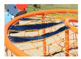
Die Corocord Membranen bestehen aus rutschfestem, gummiertem Material in Förderband-Qualität, das eine exzellente UV-Beständigkeit aufweist. Die geprüfte Konformität mit den REACH-Anforderungen für PAK ist gegeben. In die Membranen ist eine vierlagige Armierung aus gewebtem Polyester eingebettet. Die Armierung und die doppelte Oberflächenschicht ergeben eine Gesamtstärke
