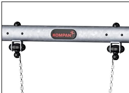
Le staffe a battente sono realizzate in nylon di alta qualità stabilizzato ai raggi UV (PA6) con cuscinetti a sfera integrati sigillati a vita. Le catene regolabili in altezza sono fissate da un gancio in acciaio inossidabile con bullone a occhiello serpente antifurto in un alloggiamento anti-rotazione. Tutti i sedili con due fissaggi a catena sono disponibili con sospensione standard o anti-avvolgimento.
