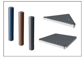
立柱由优质预镀锌钢制成,表面覆盖粉末涂层。 柱顶由防紫外线的尼龙 (PA6) 盖封闭。灰色模压 平台底板由 75% 海洋渔业消费后可循环 PP 材料 制成,表面有防滑图案和纹理。所有平台底板均 由独特设计的低碳铝型材支撑,可安装多种不同 游戏板功能配件。
