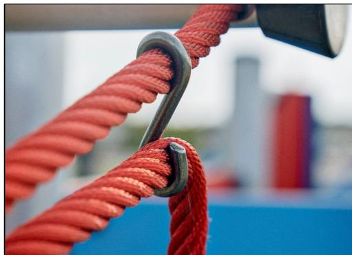
Die Corocord-S-Klemmen sind universelle Verbindungselemente aus rostfreiem Edelstahl mit einem Durchmesser von 8 mm. Die Klemmen sind abgerundet und das gesamte Bauteil wird mit hydraulischen Spezialwerkzeugen auf das Seil gepresst. Daher können die Klemmen mit herkömmlichen Werkzeugen nicht entfernt werden.
