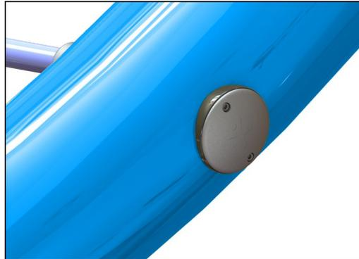
绳索通过独特的 KOMPAN 设计的拧紧解决方案固定在大型钢管上。它由内部和外部尼龙（PA6）衬套组成，该衬套将绳索引导到拉紧绳索的外部带螺纹不锈钢零件上。
