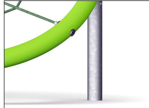
彩色钢部件具有热浸镀锌的基础和粉末涂层的顶部涂层。这在全世界各地的所有气候条件下都具有极高的耐腐蚀性。其他钢表面在内部和外部均用无铅锌进行热浸镀锌。
