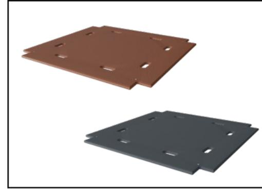
地板和面板有两种类型的材料：厚度为 21.5mm 的防水胶合板，由松木和赤杨木制成，两侧均带有防滑膜。高压层压板 HPL 厚度 17.8mm，根据 EN 438-6 具有防滑表面纹理。
