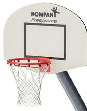
Le panier de basket est fabriqué en acier galvanisé à chaud avec un revêtement en poudre. Le filet est constitué de maillons de chaîne Ø4 en acier galvanisé s235 ou de chaînes en acier inoxydable qui répondent aux exigences des normes ISO1434-ISO1435 et DIN766. Les chaînes ont une circonférence de ~Ø30cm en bas et ~Ø50cm en haut.
