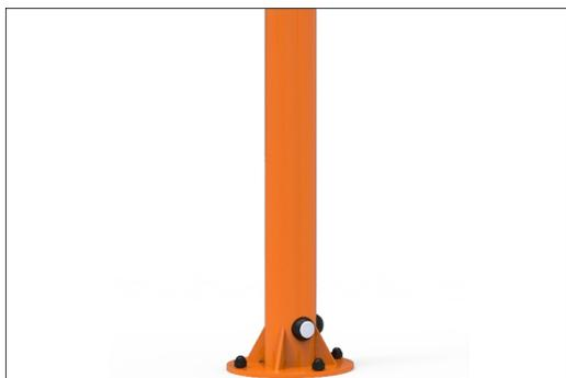
I montanti in acciaio sono realizzati con tubi in acciaio pre-galvanizzato Ø101,6x2,0 mm. I montanti sono verniciati a polvere, classe di corrosione C3 secondo ISO12944-2.
