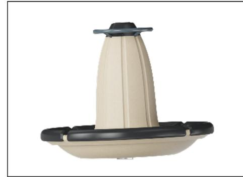
Der zentrale Teil des Boogie Spinner besteht aus recycelbarem Polyethylen (PE), das zu 33 % aus Post-Consumer-Materialien hergestellt wird. Er wird in einem Stück rotationsgeformt und verfügt über integrierte Gewindebuchsen aus Metall und Wasserabläufächer, die eine hohe Lebensdauer in allen Klimazonen der Welt gewährleisten.
