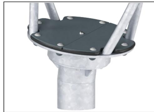
La placa superior está hecha de panel Ekogrip® que consta de una base de PE de 15 mm de espesor con una capa superior de goma blanda de 3 mm con efecto antideslizante.
