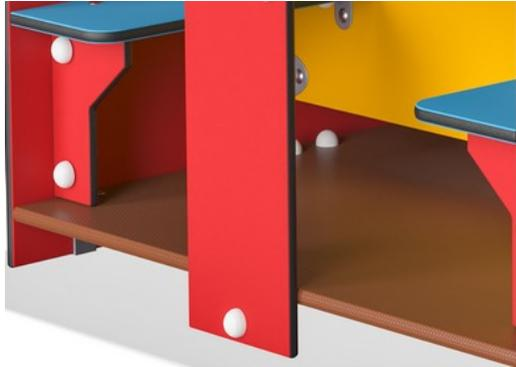
Der Boden besteht aus einer 21,5 mm dicken Siebträger-Platte aus Erlen- und Kieferholz. Beide Seiten sind mit 2 Phenolharzschichten überzogen und besitzen eine Anti-Rutsch-Struktur. Alle Schnittkanten sind mit Farbe versiegelt, um eine lange Lebensdauer zu gewährleisten.
