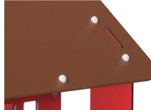
Das Dach besteht aus einer 16 mm dicken Siebträger-Platte aus Kiefern- und Erlenholz. Beide Seiten sind mit 2 Lagen Phenolfilm mit Antirutsch-Beschichtung bedeckt. Alle Schnittkanten sind mit Farbe versiegelt, um eine lange Lebensdauer zu gewährleisten.
