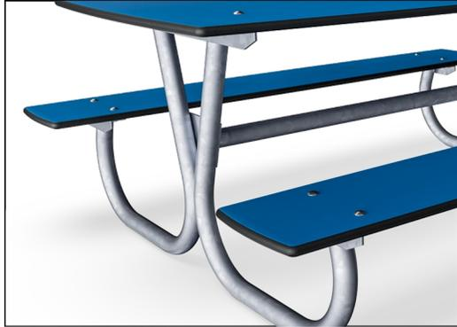
根据 EN 438-6, 所有板均由厚度为 17.8mm 的高压层压 HPL 制成, 并具有防滑表面纹理。多层结构使板经久耐用, 适合户外使用, 具有高紫外线稳定性和高抗冲击、耐刮擦、防火、防水和防潮性能。
