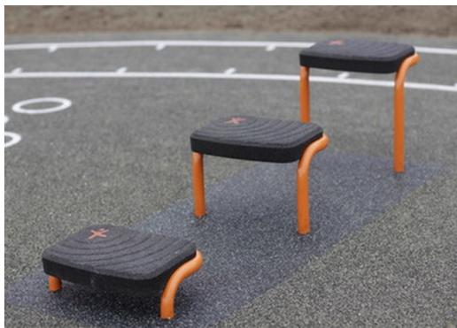
El bastidor de soporte es de 48,3 x 4 mm, acero al carbono, con una superficie galvanizada en caliente según ISO1461, y una capa de recubrimiento en polvo anticorrosión clase C3 según ISO12944-2. El contenido de plomo para las superficies es inferior a 90 ppm.
