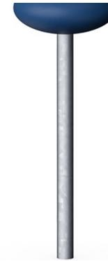
Le tube du Grasshopper est constitué d'un tube en acier galvanisé à chaud Ø48,3 x 2,9mm. Le siège supérieur est relié par un boulon M12 et recouvert d'un capuchon supérieur en PE.
