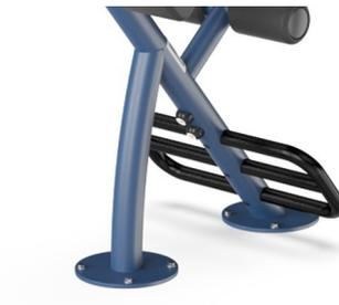
Alle Stahlteile sind aus Kohlenstoffstahl gefertigt, mit einer feuerverzinkten Oberfläche gemäß ISO1461 und einer Pulverbeschichtung der Korrosionsklasse C3 gemäß ISO12944-2. Der Bleigehalt der Oberflächen liegt unter 90ppm, der des Grundmaterials unter 100ppm.
