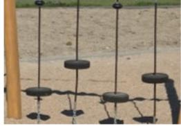
Sièges en caoutchouc EPDM entièrement colorés avec surface lisse. Les sièges sont moulés sur un renfort interne rigide en acier galvanisé à chaud qui assure une fixation durable à la corde.
