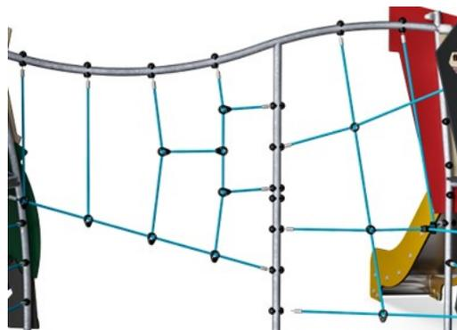
Le reti da arrampicata sono realizzate in corda di PP stabilizzata ai raggi UV con rinforzo interno in cavo d'acciaio. La fune è trattata per induzione per ottenere il massimo fissaggio tra acciaio e fune che offre un'eccellente resistenza all'usura. Tutti i connettori delle funi sono realizzati in materiale PA riciclabile al 100%.
