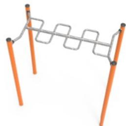
L'échelle serpentine est fabriquée en acier S235 galvanisé à chaud avec les dimensions suivantes : Ø38 x 4 mm. Les surfaces en acier sont galvanisées à chaud à l'intérieur et à l'extérieur avec du zinc sans plomb. La galvanisation offre une excellente résistance à la corrosion en extérieur et nécessite peu d'entretien.
